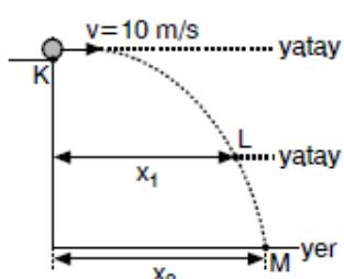
Şekildeki K noktasından yatay bir hızla atılan cisim K noktasından L noktasına 2 s de L noktasından M noktasına 1 s de gelmektedir.
